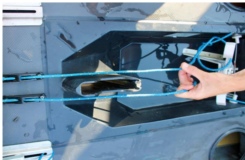
Figuur 20: Twee lijnen voor de bepaling van de stand van het roer
