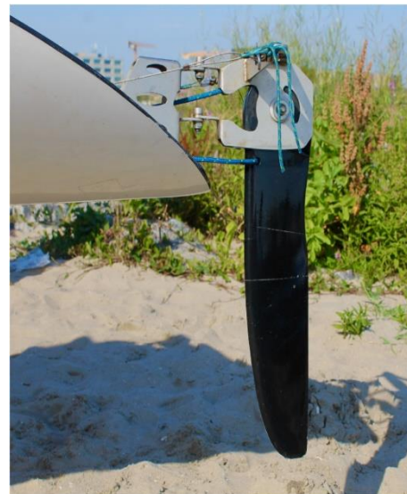
Figuur 19: Roer in verticale positie
