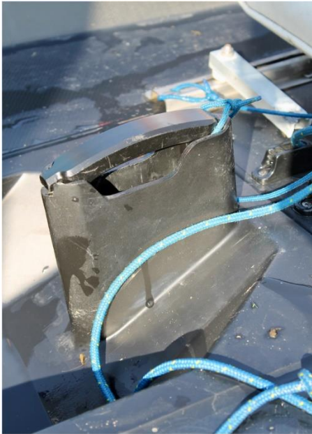
Figuur 23: Vin volledig omlaag
