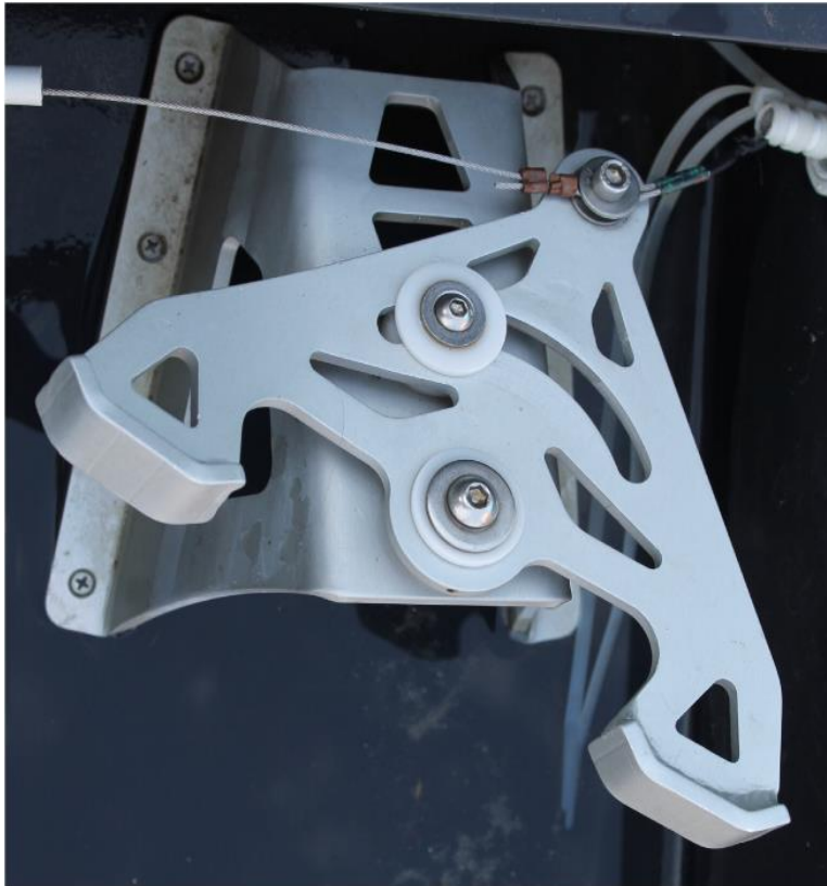
Figuur 17: Het stuurpedaal van de Wim Koopman
