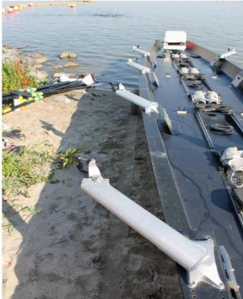
Figuur 5: De coastalroeiboot is breder, met kortere riggers
