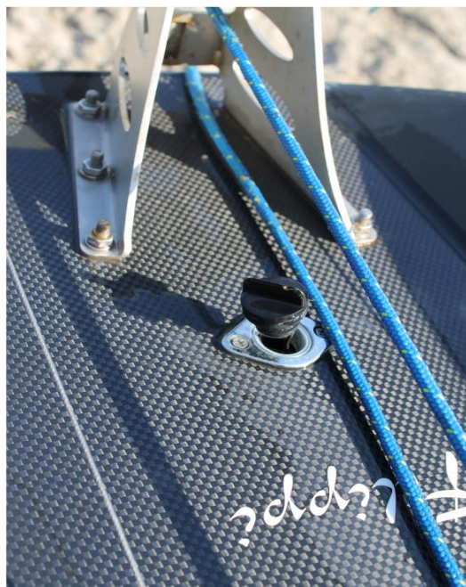
Figuur 7: Luchtklepje achter de stuur
